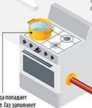
От долгой или неправильной эксплуатации происходит разрыв шланга, соединяющего газовую магистраль с плитой. Газ постепенно заполняет помещение. Искра – взрыв
