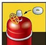
Прокладку между краем баллона и регулятором менять при каждой новой установке
