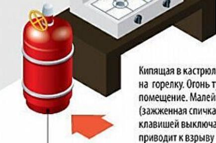
Кипящая в кастрюле вода попадает на горелку. Огонь тухнет. Газ заполняет помещение. Малейшая искра (зажженная спичка, нажатие клавишей выключателей и т.д.) приводит к взрыву
