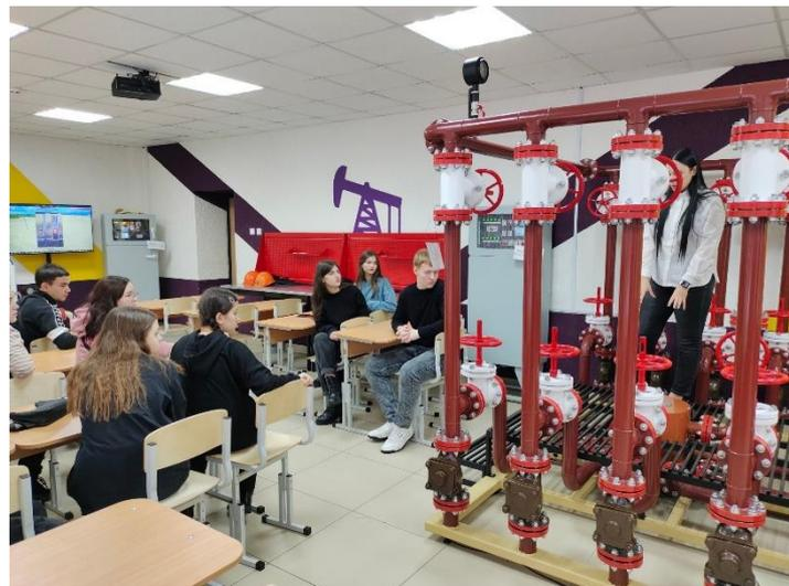
В программе ребята сперва включали вентиляцию так как в данном помещении находится пары газа, что опасно для жизни. И только после могли зайти и работать в данном устройстве. Задача ребят была открыть и закрыть нужные вентили так чтобы нефть прошла в бак для измерения.
